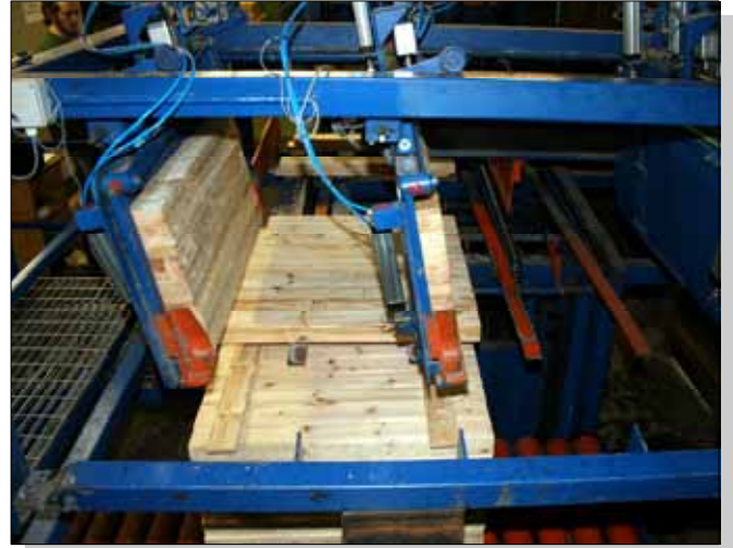
6. Empilage, utilisant des planches comme lattes
