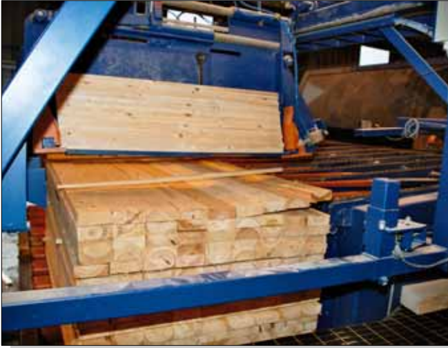
5. Empileur de standard avec pose de lattes
