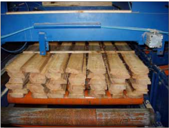
11. Empilage en rangs de planches re -sciées en lamelles
