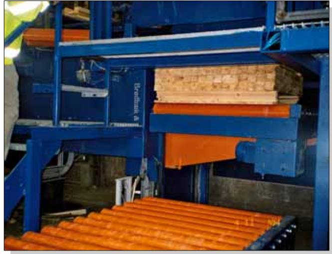
19. En utilisant des planches en-dessous comme pieds, les paquets seraient faciles à prendre avec le chariot élévateur à fourche.
