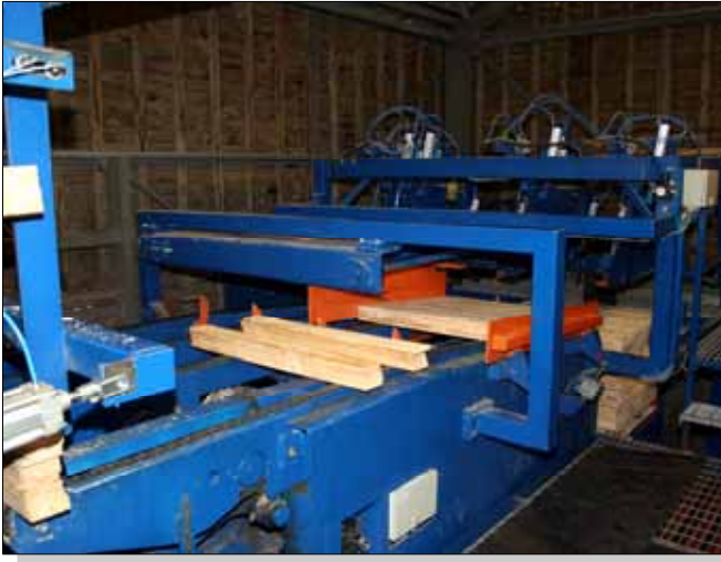
16. Mise en butée des rangs en entrant l'empileur de grande capacité
