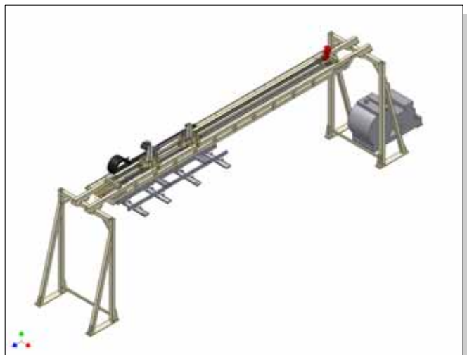
4. Dépilage en rangs longitudinalement à vide par contacteur de dépression
