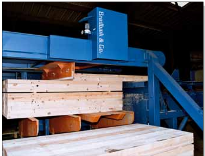
2. Dépilage en rangs longitudinalement en utilisant une barre poussoir
