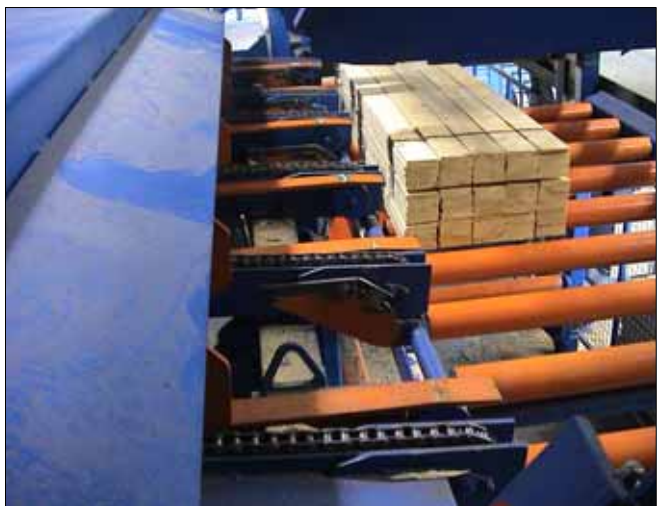
12. Le cerclage de paquets peut se faire avant l'empilage
