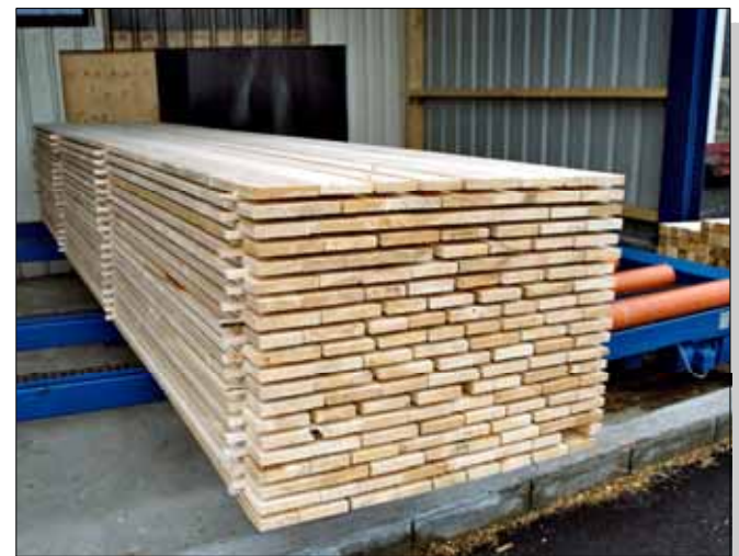
9. Empilage de largeurs mixtes par écart horizontal entre chaque rang – bien approprié pour le séchage
