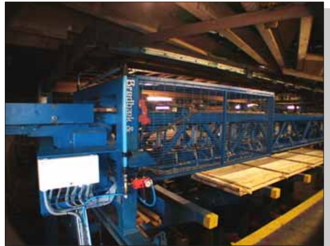
8. BCO Stick Robot prévu pour le positionnement, jusqu'à 120 lattes/min.
