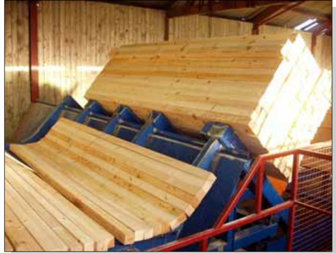
1. Dépilage en utilisant une dépileuse inclinable
