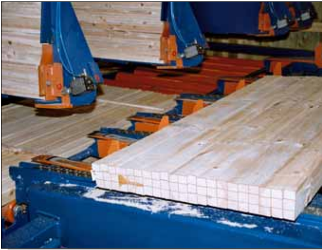
10. Empilage en rangs de bois ré -scié en lattes
