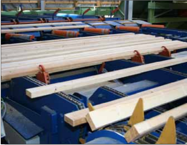
13. Le distributeur pièce par pièce, BCO Speed Feeder vous assure la maîtrise sûre d'un produit
