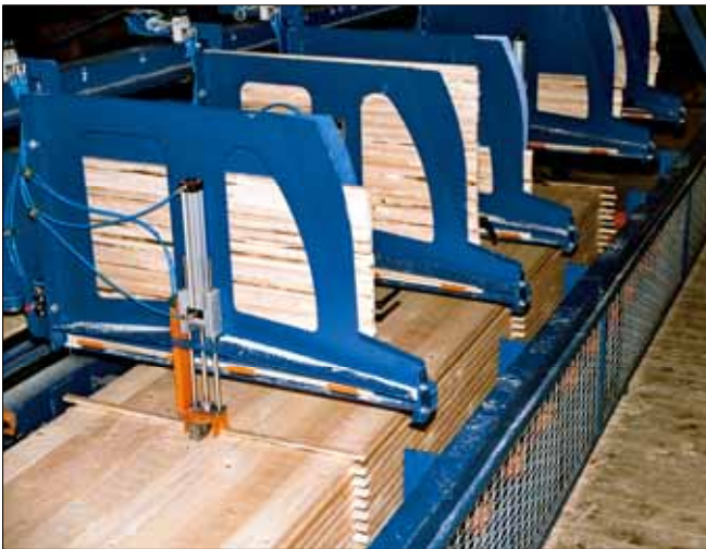
7. Magasins à lattes, opération très rapide et précise
