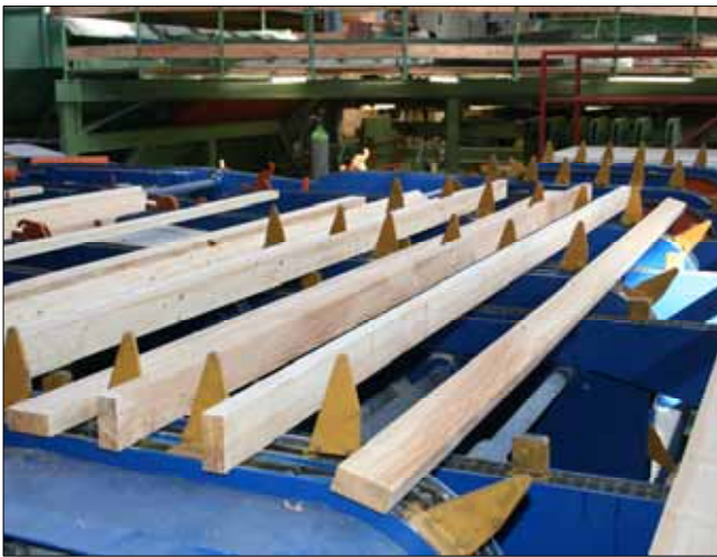
14. Retourneur de type "Aileron de requin" pour une inspection rapide et facile
